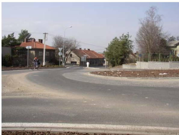
Obr. 11: Plochý a nevýrazný střední ostrov (ČR)
