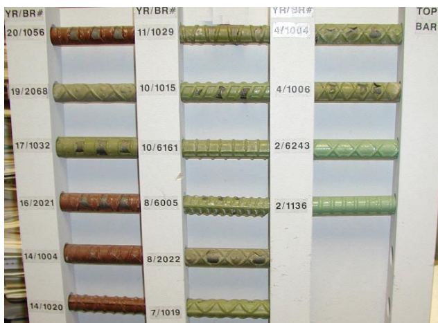
Obr. 3 – Degradace epoxidového povlaku v průběhu času (obrázek byl pořizen ve Virginia Transport Research Council)
