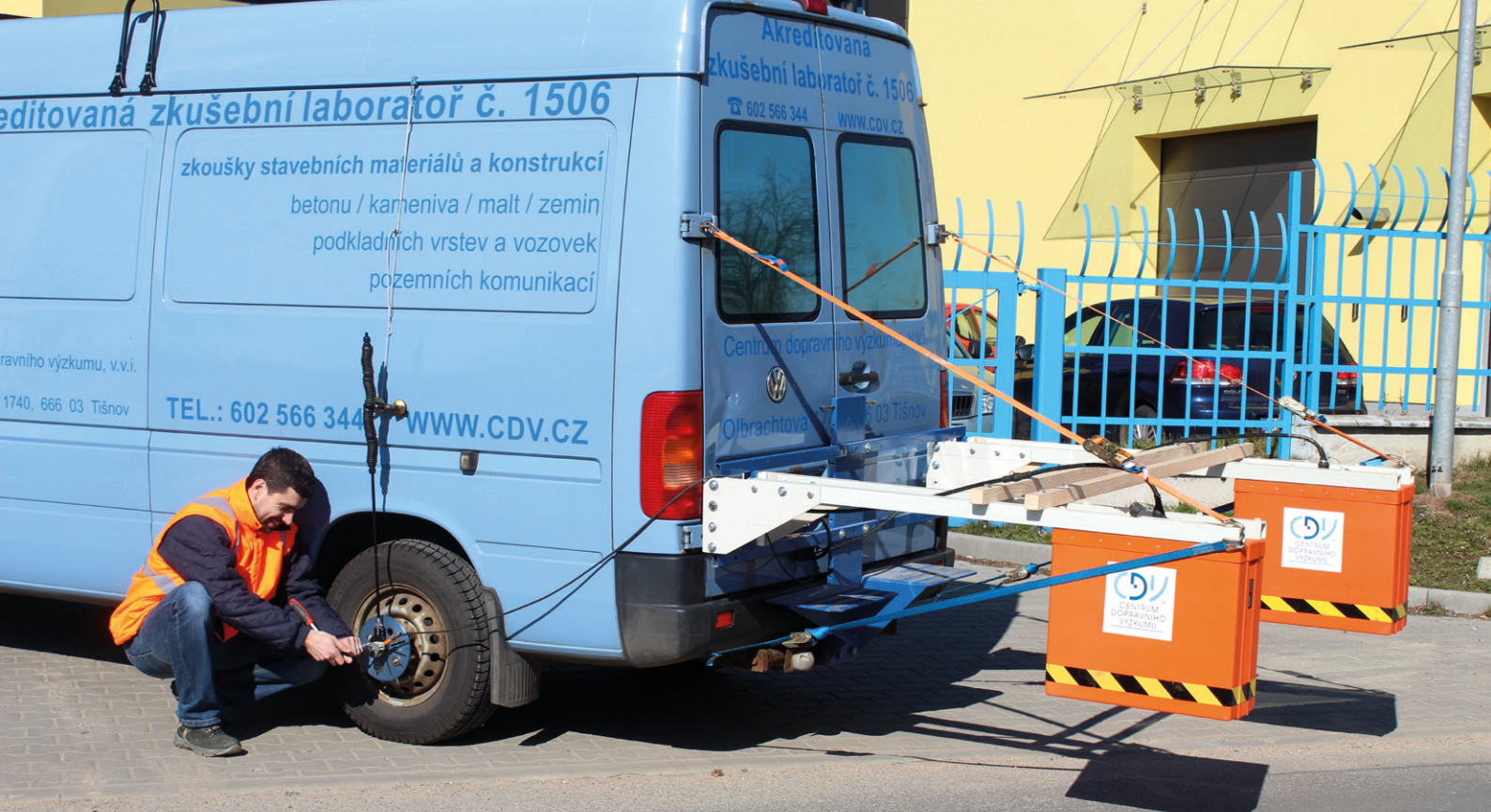
Georadar - systém RoadScan pro diagnostiku vozovek; osazení zařízení pro měření ujeté vzdálenosti na vozidlo
