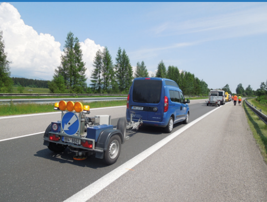
Měření průhybů rázovým zařízením FWD/HWD na vozovce s asfaltovým krytem
