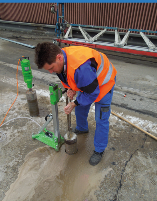
Vyjmutí jádrového vývrtu z cementobetonového krytu
