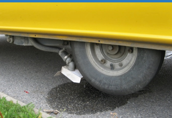
Měřicí kolo s kropicím zařízením pro smáčení povrchu vozovky v průběhu měření
