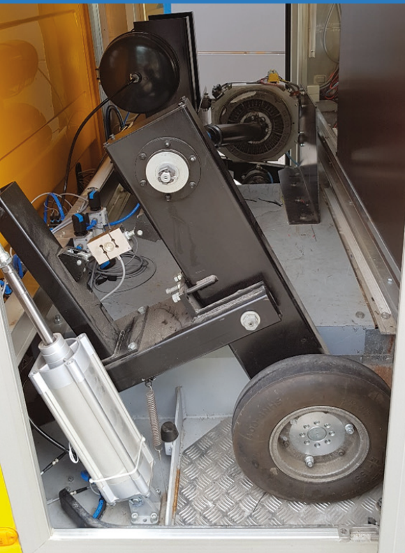
Závěs se systémy pro kontrolu přítlaču a brzdění měřicího kola
