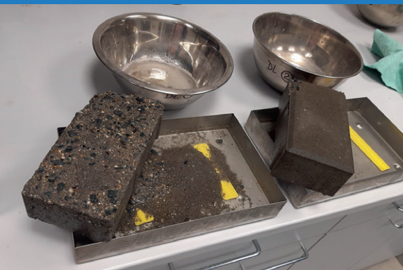
Rozdíl v odpadu neošetřené a ošetřené dlažby po 50 zmrazovacích cyklech
