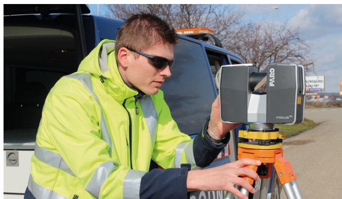
Skenování místa dopravní nehody pomocí 3D skeneru
