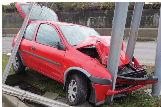
Náraz do konstrukce dopravního značení
