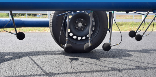
Detail na rozmístění měřících mikrofonů okolo standardní referenční pneumatiky
