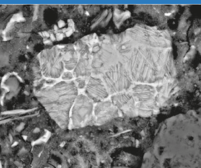
Povrch póru v betonu - krystaly portlanditu a ettringitu
