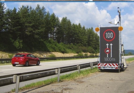
Mobilní telematické informační zařízení sloužící k regulaci dopravy v reálném čase Foto: archiv CDV
