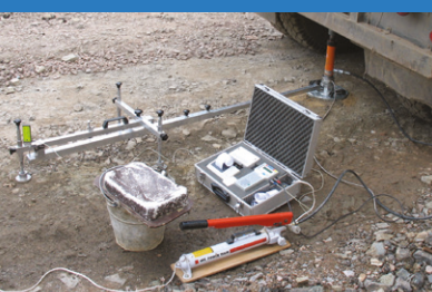
Kontrola hutnění zemin statickou zatěžovací zkouškou | Foto: archiv CDV
