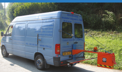
Měření tloušťek vrstev georadarem Foto: archiv CDV
