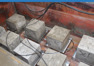
Stanovení mrazuvzdornosti betonu | Foto: archiv CDV
