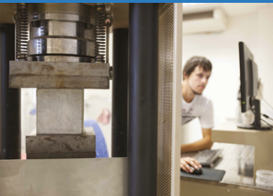
Stanovení pevnosti betonu v tlaku | Foto: Stanislav Pecháček
