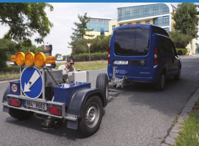
Měření rázovým zařízením FWD | Foto: Stanislav Pecháček
