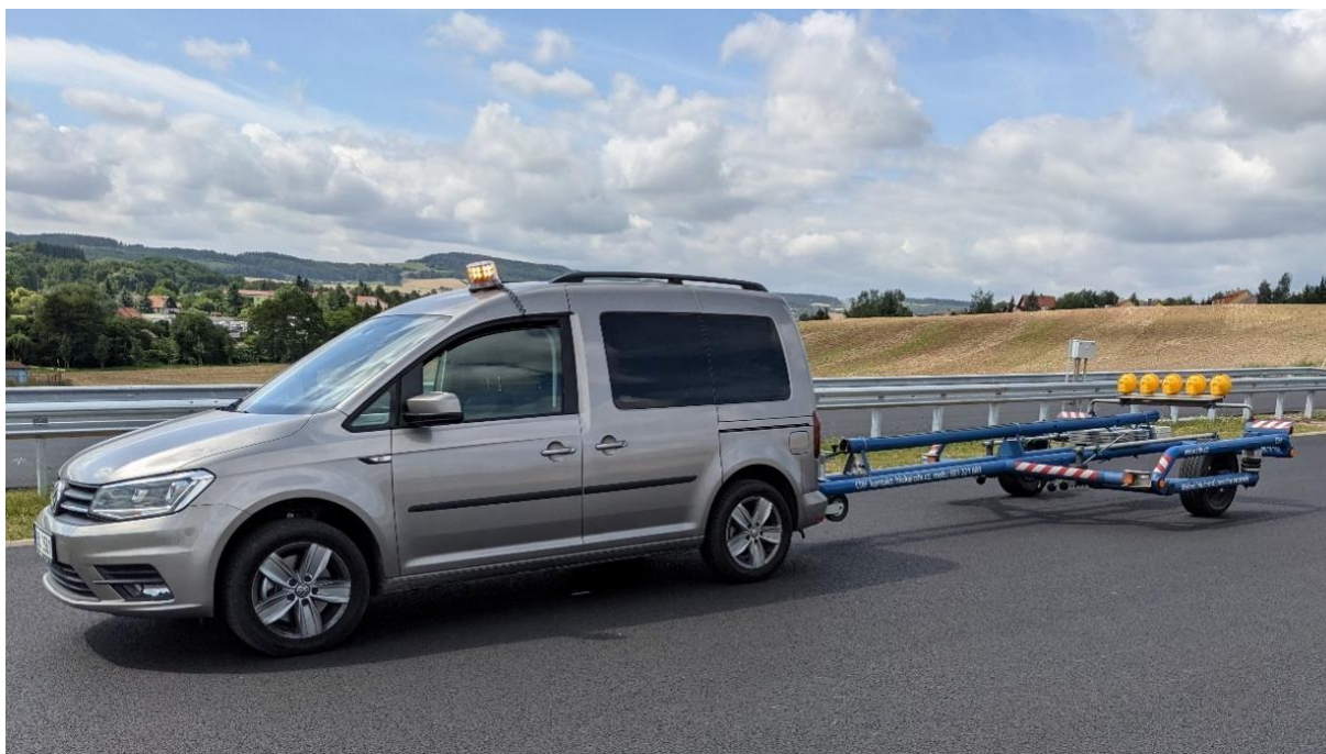
Obrázek 3 Specializovaný přívěs CDV připravený k provedení měření dle metody CPX.
