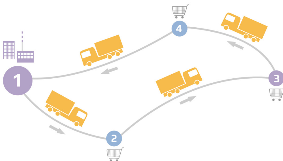
Obr. 11 Znárodnění tour-based přístupu v nákladní dopravě (cesta: sklad - obchod - obchod - obchod - sklad)
