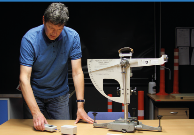
Porovnání velikostí dvou různých zařízení v prostředí laboratoře: vlevo nové zařízení, vpravo kyvadlo
