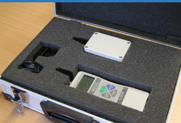
Měřicí zařízení ke zjišťování podélného koeficientu tření povrchu vozovek v přepravním obalu
