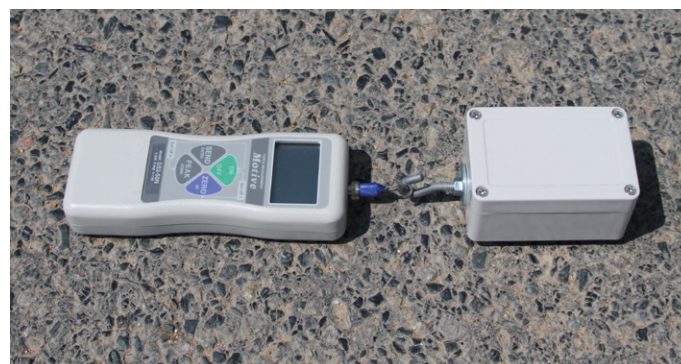
Měřicí zařízení ke zjišťování podélného koeficientu tření povrchu vozovek
