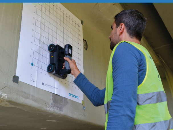
Georadarové měření – plošný sken s využitím rastru
