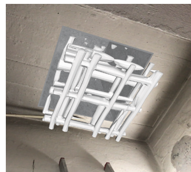
Promítnutý georadarový sken na povrch konstrukce s využitím rozšířené reality
