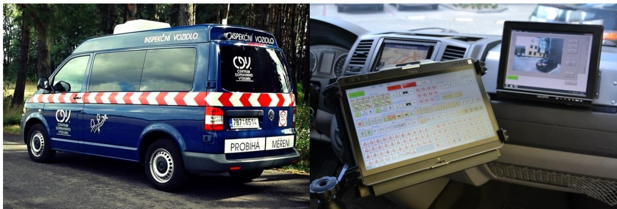
Inspekční vozidlo CDV, používané pro sběr dat o rizikových faktorech silniční sítě
