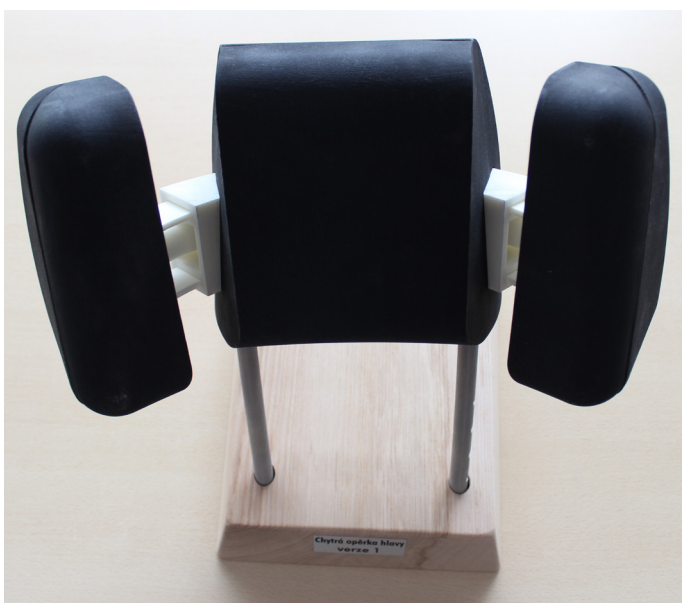
model aktivní opěrky z 3D tiskárny
